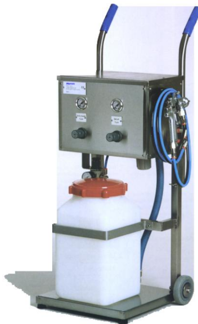
B900 ämnessmörjare är försedd med fällbara in- och utmatningsbord samt sväng- och låsbara hjul. Detta gör enheten flexibel och snabb att sätta i produktion.
